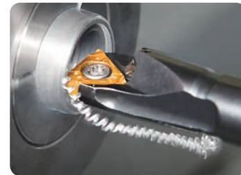
F1 chipbreakers evacuates chips BACKWARD (S-STUC style shown)
